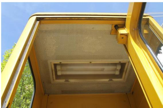
Abb. 3: Decke mit Lochblech und Beleuchtung (Verf.03.05.2018)
