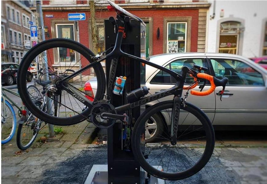
**Bild 9:** Beispiel für eine Bike-Repair-Station in Form einer Reparaturstele
