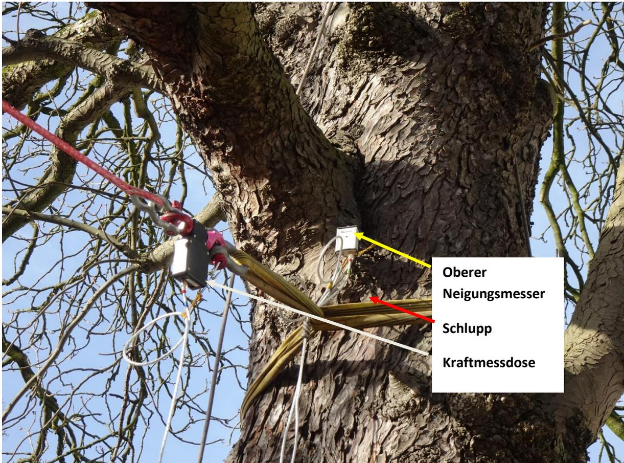
Abb. 4 und 4a: Positionen des oberen Neigungsmessers, des Schlupps und der Kraftmessdose beim Zugversuch
