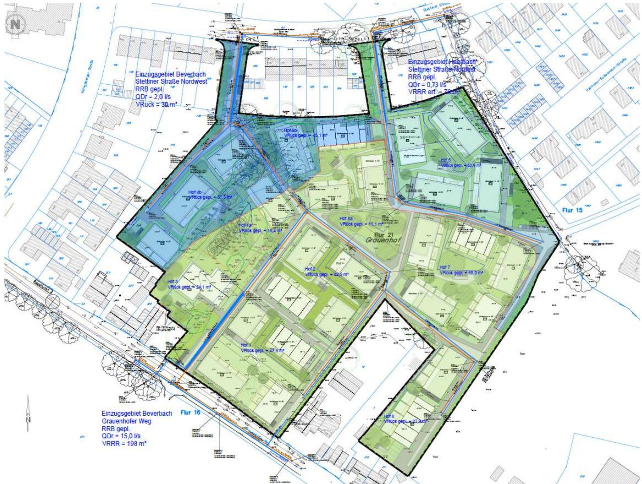
**Abb. 8:** Lageplan Geländemulden, unterirdische Regenrückhaltekanäle bzw. Rückhaltebauwerke (RRB)
