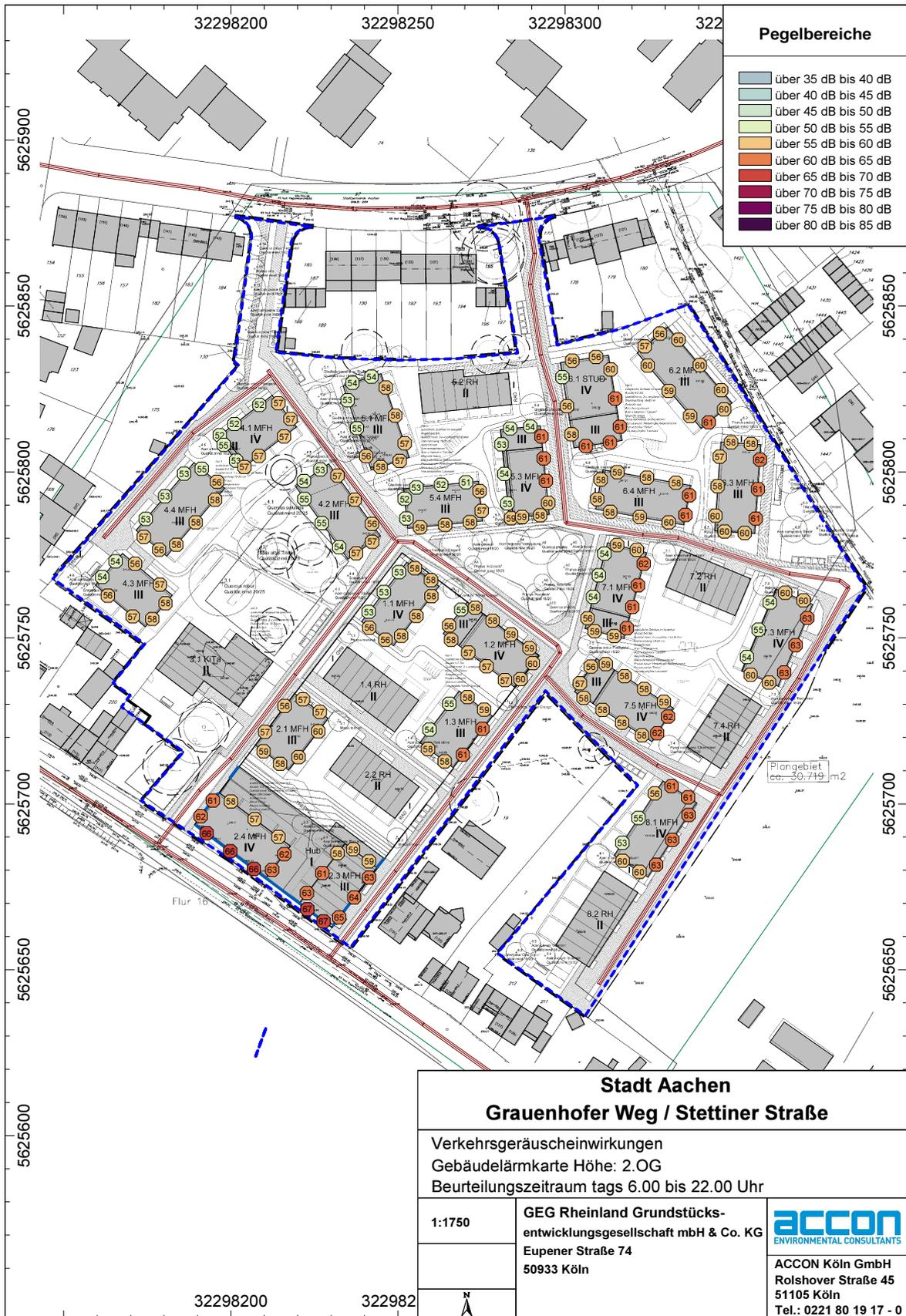
**Abb. 4.2.11** Gebäudelärmkarte der Straßenverkehrsgeräusche an den Fassaden eines Bebauungskonzepts in Höhe des 2.OG, tags
