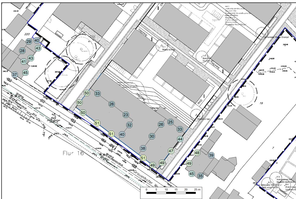
**Abb. 5.1.1** Beurteilungspegel durch die Nutzung des Mobility Hub und der Tiefgarage am Beispiel einer möglichen Bebauung, tags
