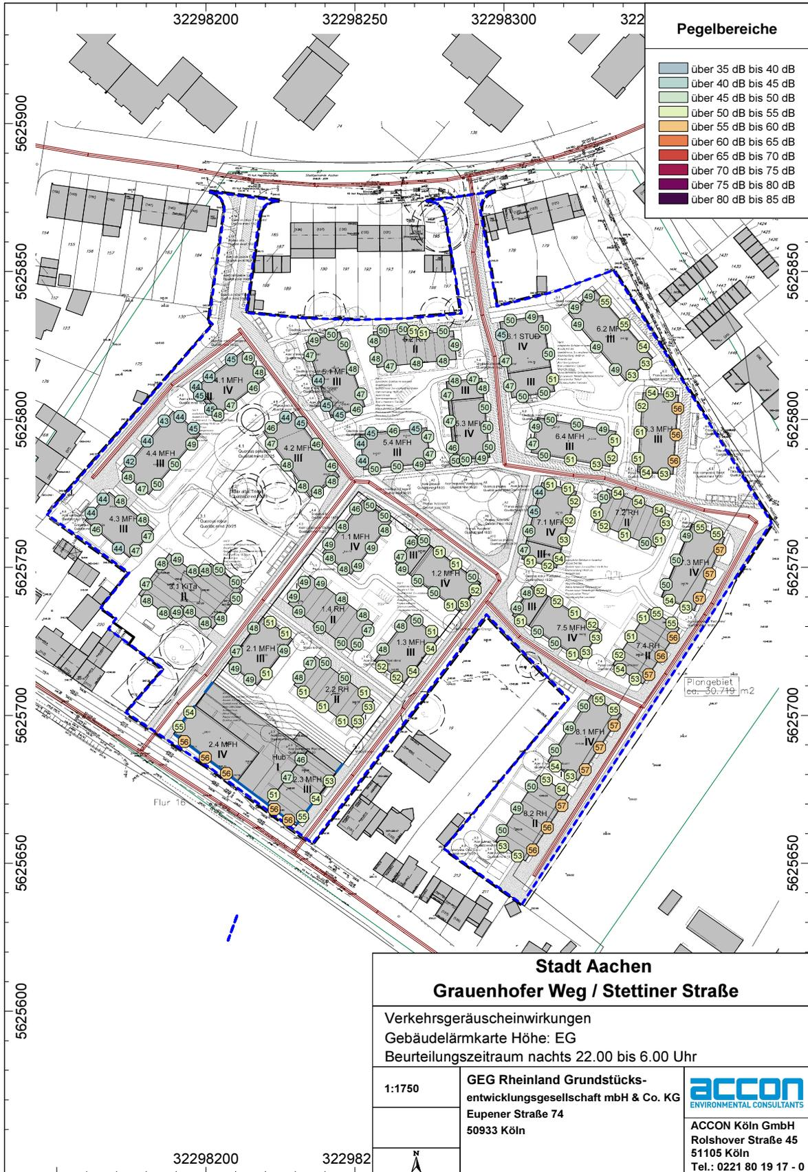
**Abb. 4.2.13** Gebäudelärmkarte der Straßenverkehrsgeräusche an den Fassaden eines Bebauungskonzepts in Höhe des EG, nachts
