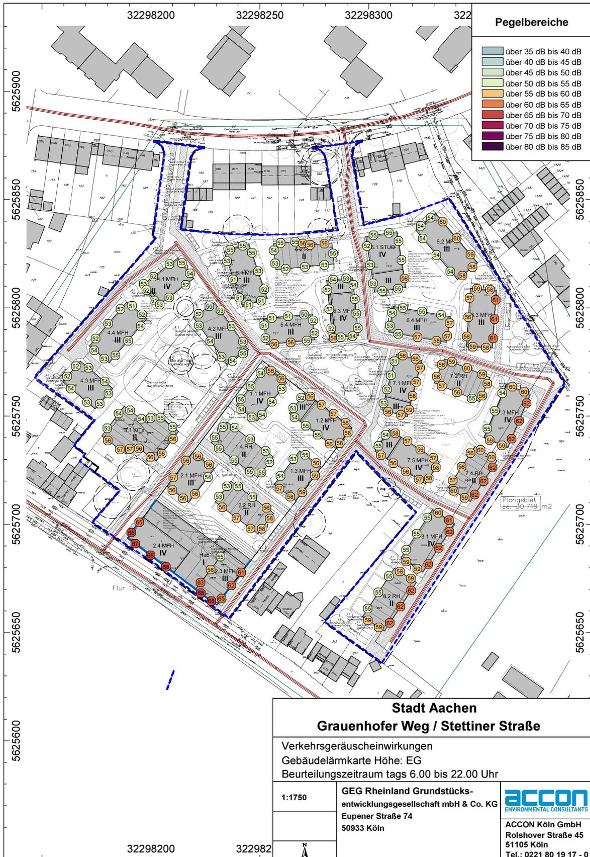
**Abb. 4.2.9** Gebäudelärmkarte der Straßenverkehrsgeräusche an den Fassaden eines Bebauungskonzepts in Höhe des EG, tags
