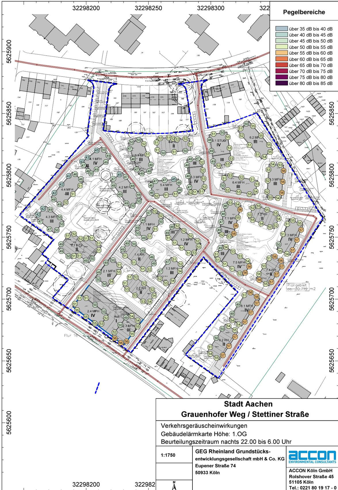
**Abb. 4.2.14** Gebäudelärmkarte der Straßenverkehrsgeräusche an den Fassaden eines Bebauungskonzepts in Höhe des 1.OG, nachts
