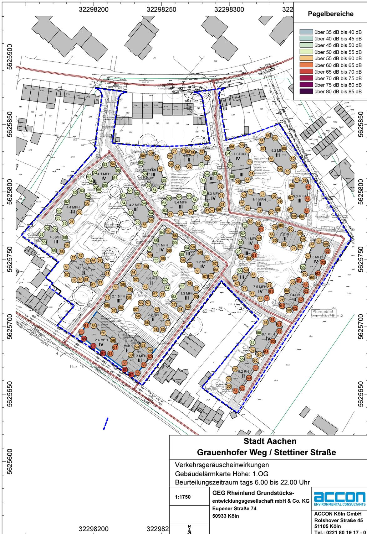
**Abb. 4.2.10** Gebäudelärmkarte der Straßenverkehrsgeräusche an den Fassaden eines Bebauungskonzepts in Höhe des 1.OG, tags
