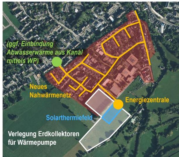
Abbildung 80: Beispielhaftes Nahwärmeconcept für das Schulviertel in Kornelimünster mit einem Solarthermiefeld sowie einem (nach Installation wieder nutzbaren) Erdkollektorfeld für eine Wärmepumpe. Möglich ist zudem die Einbindung von Abwasserwärme aus dem Kanal in der Schleckheimer Str.
