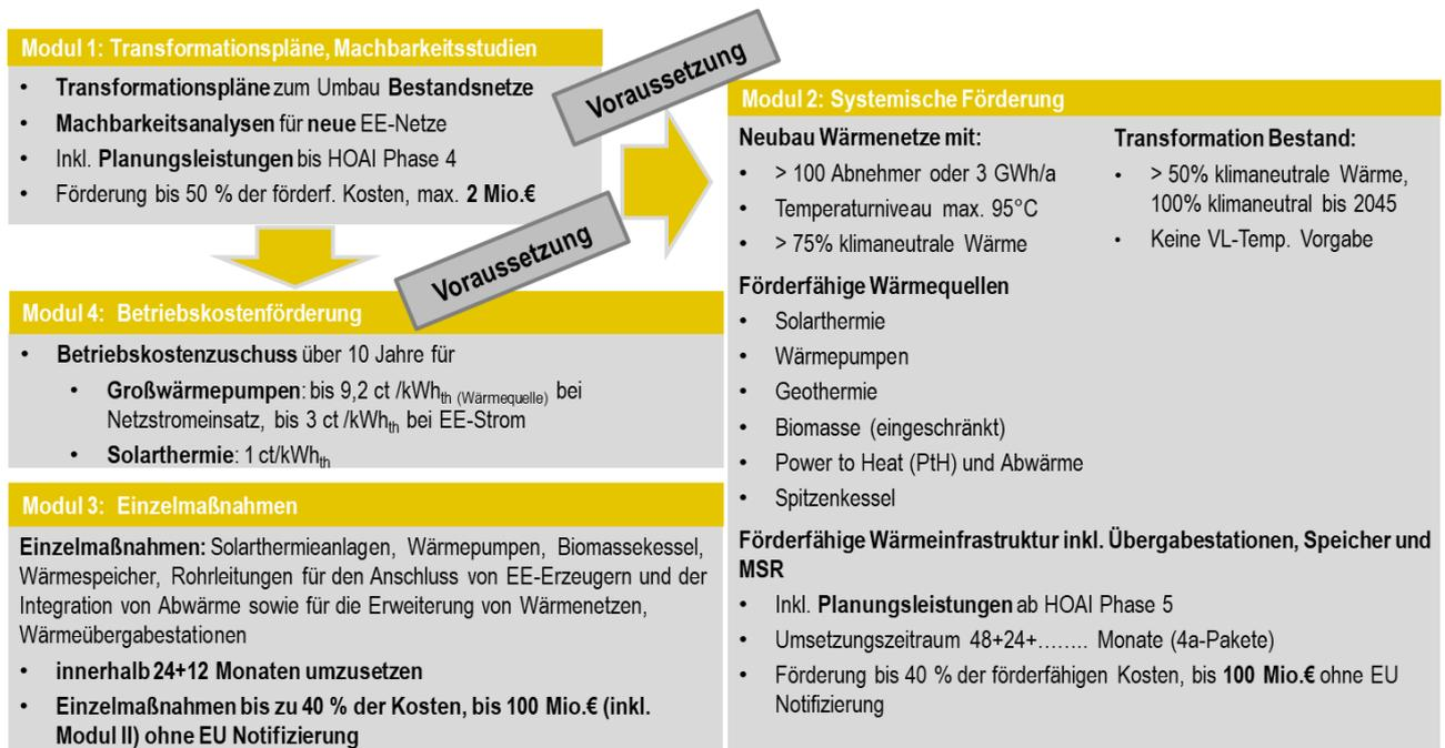
Abbildung 12: Übersicht der Bundesförderung für effiziente Wärmenetze (BEW)
